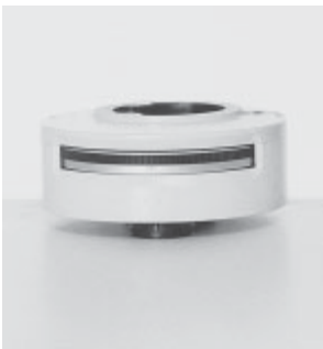
Fig. 28 Changeur de grossissement
