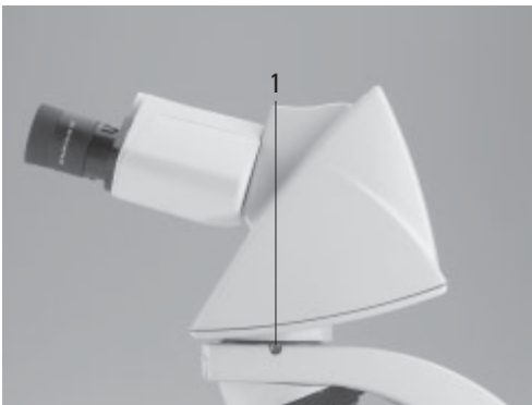
Abb. 11 Befestigen des Tubus 1 Klemmschraube
