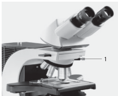
Fig. 64 Coulisseau de prismes d'objectif
